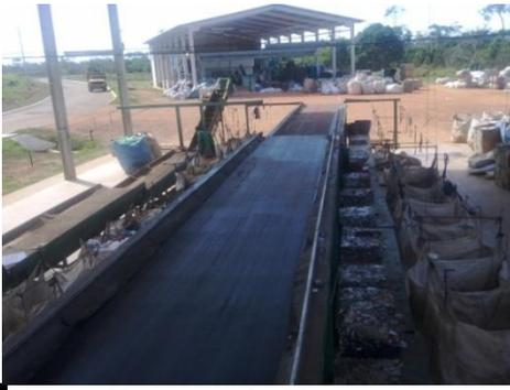
**Foto: Esteira de Triagem em perfeitas condições para operação**
