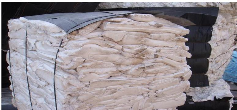
**Foto de fardo de isopor na ARCS, onde se pretende implantar uma nova agregação de valor a este material reciclável. Como se sabe, o isopor é PS( Poliestireno) expandido. Com a utilização de um equipamento novo, a ARCS pretende retirar a expansão do ISOPOR para fazer grãos de PS com o objetivo de vender para indústrias que processam este material.**
