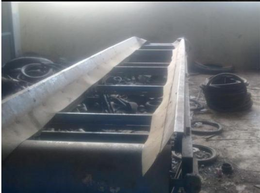
Fotos: Abertura lateral permitindo a queda por gravidade dos materiais na esteira de triagem, que no entanto encontra-se em situação de total abandono e degradação necessitando avaliação pormenorizada do seu estado.
