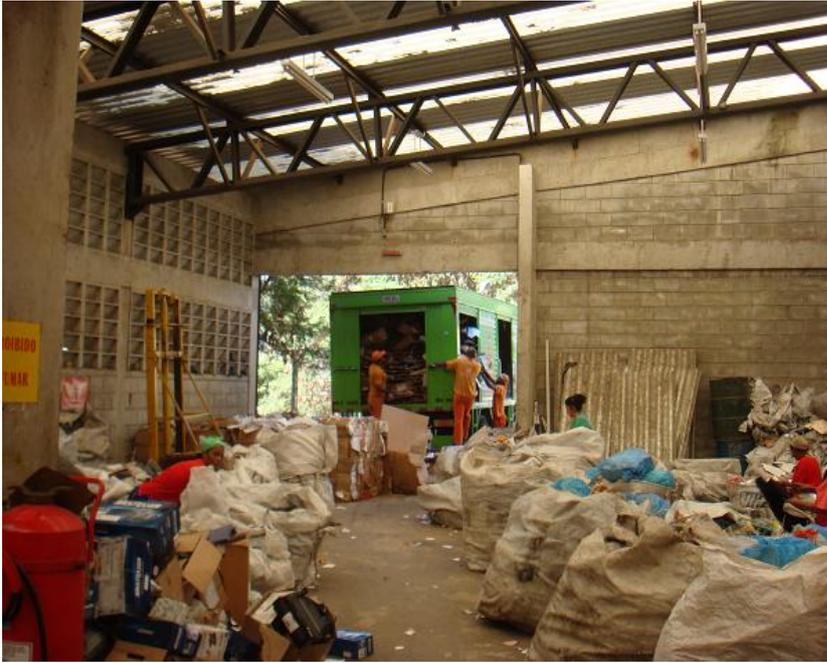
Outra parte da entrada do silo, com descida inadequada e abaixo com pequeno espaço para a recepção dos materiais que descem do silo por gravidade. A falta de uma esteira é relevante e determinante para a baixa produtividade da cooperativa.
